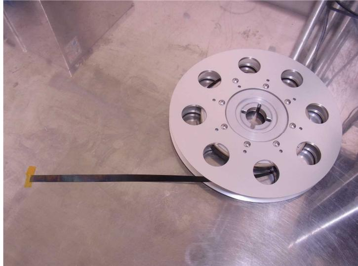
図 V1-22 Reel-to-Reel 塗布・仮焼成システムにより作製した 10m 級長尺仮焼成膜の外観写真
