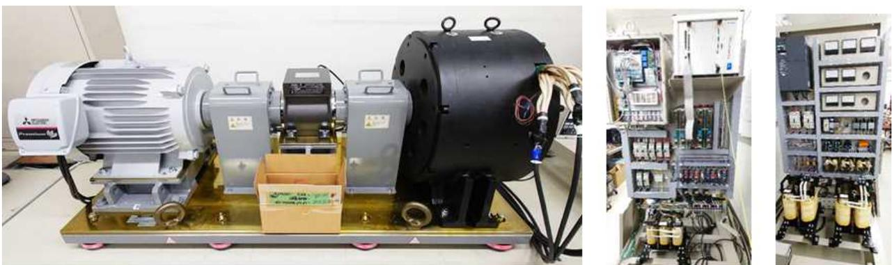
図 第一次評価用テストベッド(20kWミニモデル)
