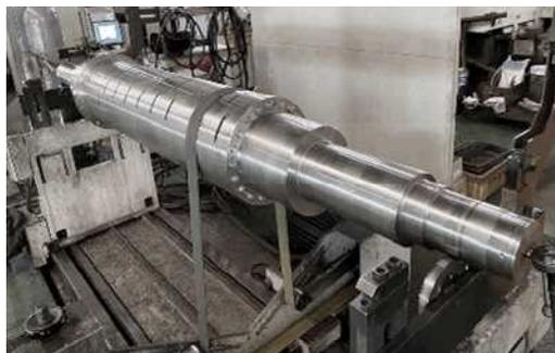
図 V1-4 軸受構造開発用冷却モデル
