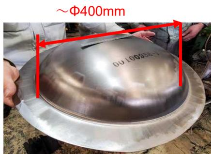
図 V1-6 開発に成功した約 400mmΦのチタン合金製の鏡板
