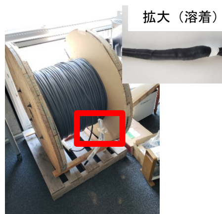
図Ⅲ (3. 1)-4 周期加熱法による熱応答試験・発熱ワイヤー付光ファイバー温度計
