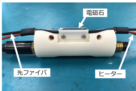
図Ⅲ (3. 1)-2 大口径水井戸に対応する熱応答試験装置の孔壁吸着機構 (試作機)
