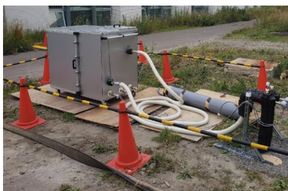
図Ⅲ (3. 1)-4 周期加熱法による熱応答試験・発熱ワイヤー付光ファイバー温度計
