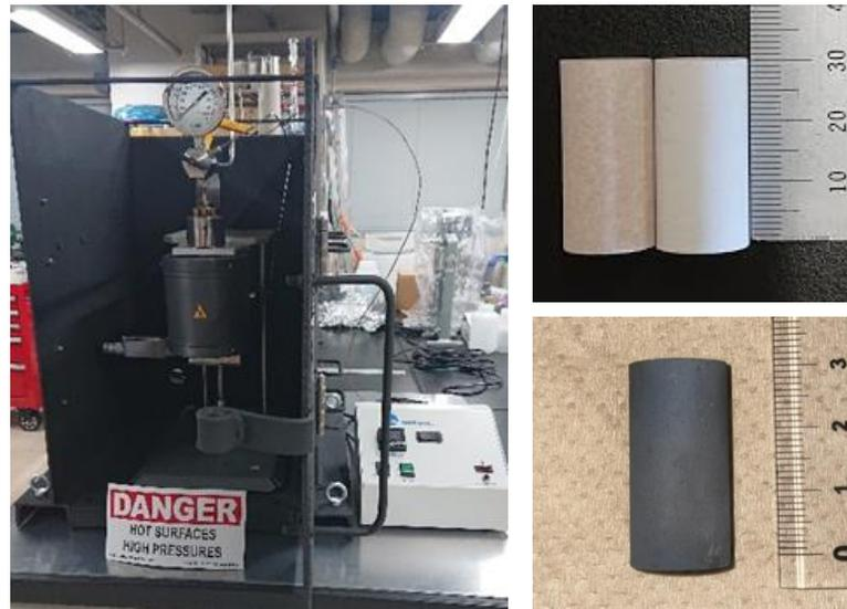
図Ⅲ(2.2)-4 超臨界セメント養生試験装置(左)、セメント試験片(右上)および試作アルミナセメントの28日養生試験後の外観(右下)
