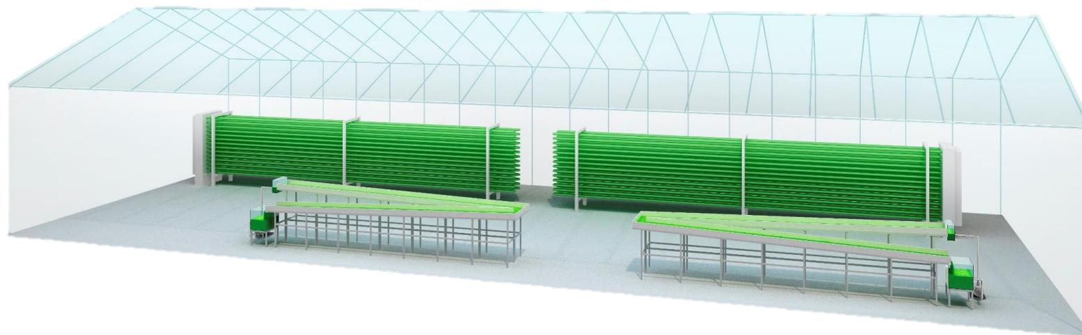
左上：元農業資材温室、左下：カスケード型の培養槽、上：チューブ型バイオリクター
