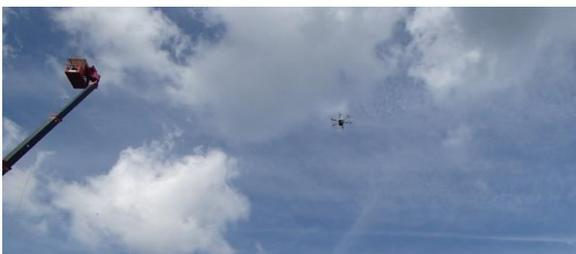
硫化水素の測定は、高所作業車やUAVを用いて、地上高以外の高さでも実施して、拡散実態を把握
