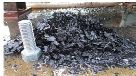
熱交換器入口に集積した剥離スケール
