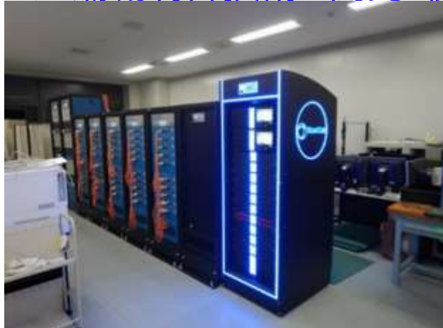
RTDS（機能検証するための電力系統シミュレータ）の写真
