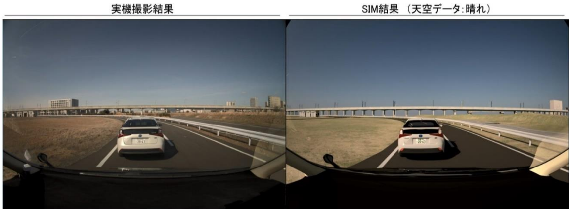
図 11 カメラの実機出力（左）とシミュレーション出力（右）
