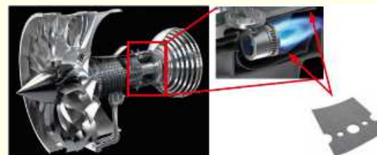
燃焼器ライナに適用したCMC (セラミックス基複合材料)
