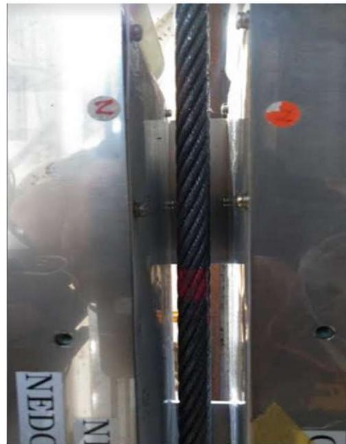
ロープとの磁化器表面からの非接触距離は、約 6 mm～8 mm程度
