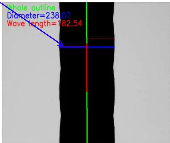
ロープ線速150m/min (露光時間200μsec、500fps)
