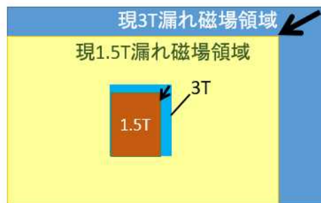
MRIマグネットの漏れ磁場、形状の概要(HTS-3Tが現1.5T並みに)
