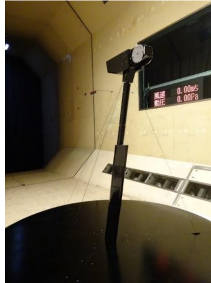
(a)歪みゲージ, 加速度センサの位置
