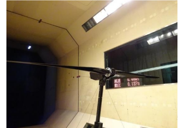
(b)模型のJAXA風洞への設置状況 (左)ブレードなし (上)ブレード水平保持
