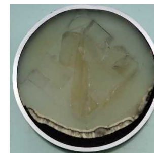
スケールが付着した配管断面
