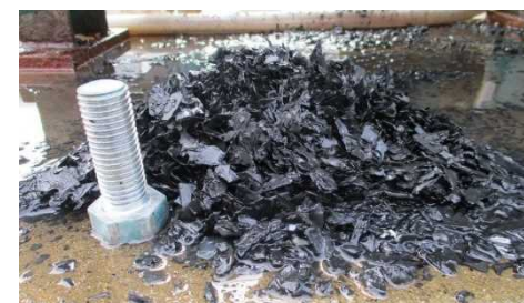
熱交換器入口に堆積した剥離スケール
