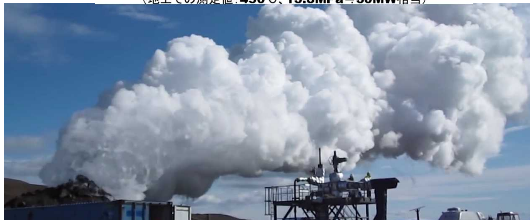
アイスランドの成果(DDP-1噴気試験) DDP-1 (Krafla地域、深度2,100m) の噴気試験(2010-2012) (地上での測定値: 450^{\circ}\text{C} 、 13.8\text{MPa} \approx 30\text{MW} 相当)
