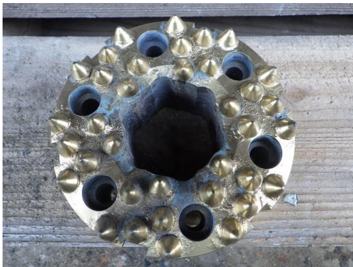
(外径φ126mm 硬質地盤層用先端チップ)
