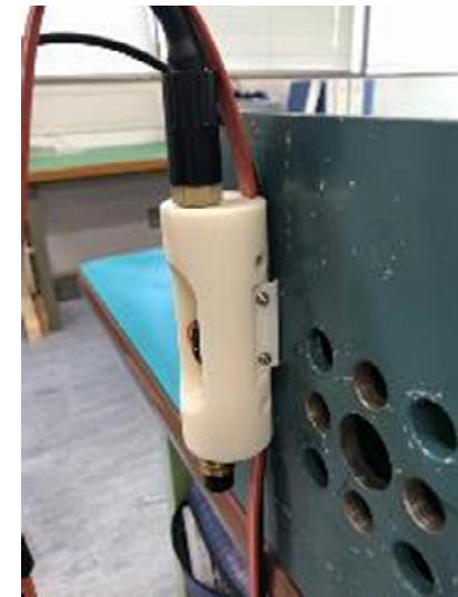
孔壁吸着機構の試作機（上）と 金属壁への吸着状況（下）
