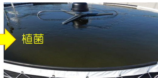
小規模既設円形ポンド型培養装置(10m³)による オイル蓄積培養
