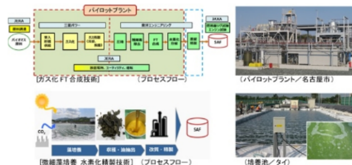
図 バイオ燃料—貫製造プロセス
