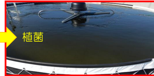
小規模既設円形pond型培養装置(10m³)による オイル蓄積培養
