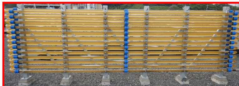
小規模既設ガラスチューブ型培養装置(0.35m³)による増殖培養
