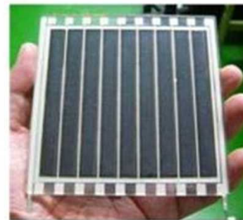
ペロブスカイト太陽電池 ミニモジュールの試作品
