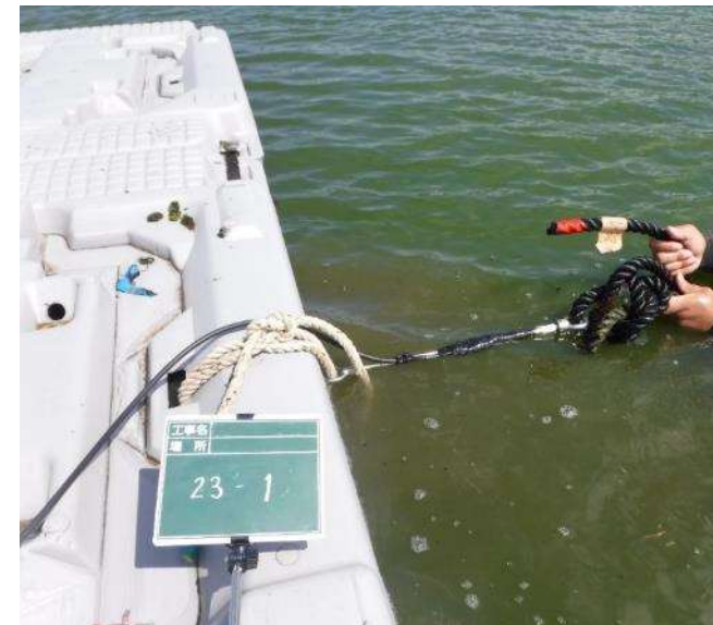
係留索への張力計設置状況
