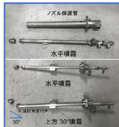
開発したノズル(一段)の設置例 (上: 三流体ノズル、下: 二流体ノズル×二種)
