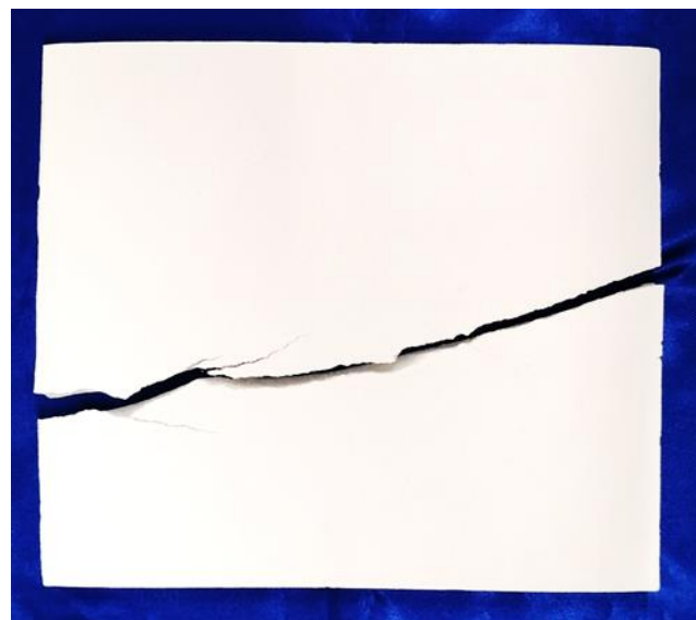
焼成時に亀裂発生した開発断熱材
