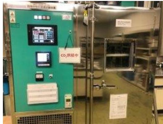
炭酸ガス養生槽(45°C-80%R.H.-CO<sub>2</sub>80%)
