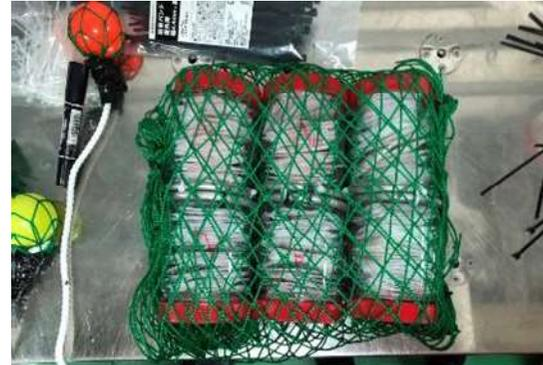
① チャンバー内に封入した多量の生分解性プラスチック候補素材
