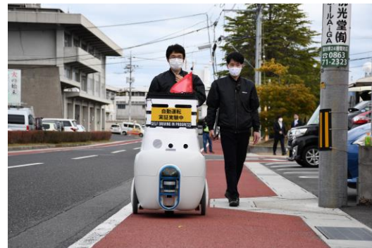
オペレーターによる近接目視
