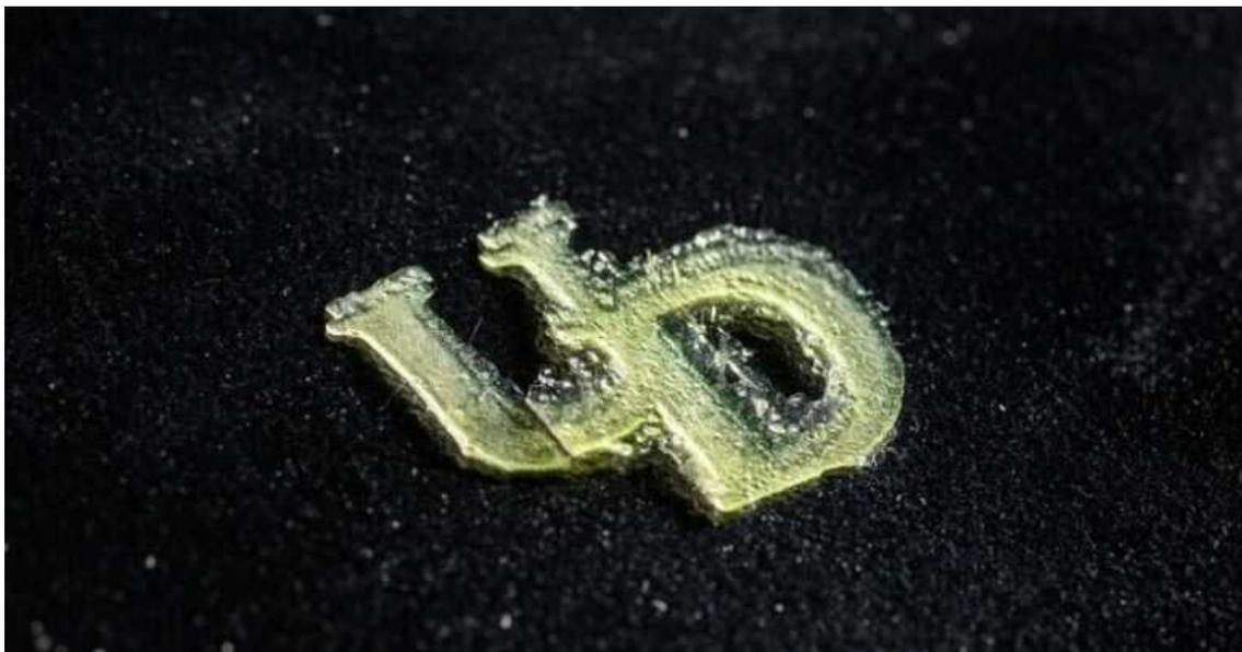
この組み合わせさせた UD は、バイオマスの技術リグニンを原料とした 3D プリント用樹脂で製作された。こすると香る写真ではないが、かすかにバーベキューの匂いがする。なぜか？UD 開発の工程から生じる芳香族化合物は、燻煙液に含まれるものと似ているのだ（提供：University of Delaware）
