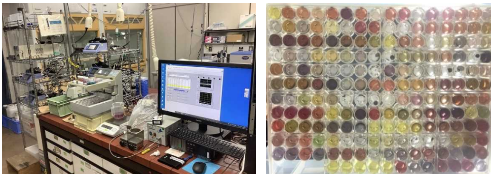
図 3-⑥-16 金属ナノ粒子の自動フロースクリーニングシステムと回収液
