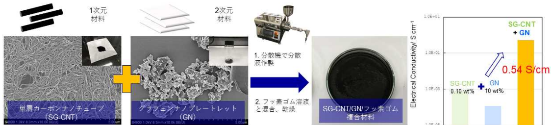
図 3-⑨-3-12 CNT/グラフェンナノプレートレット複合材料作製の模式図および得られた複合材料の導電率の一例
