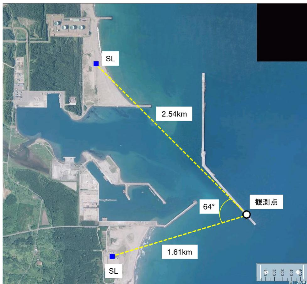
図 4.1 DSL による洋上風況観測点の例（むつ小川原港）
