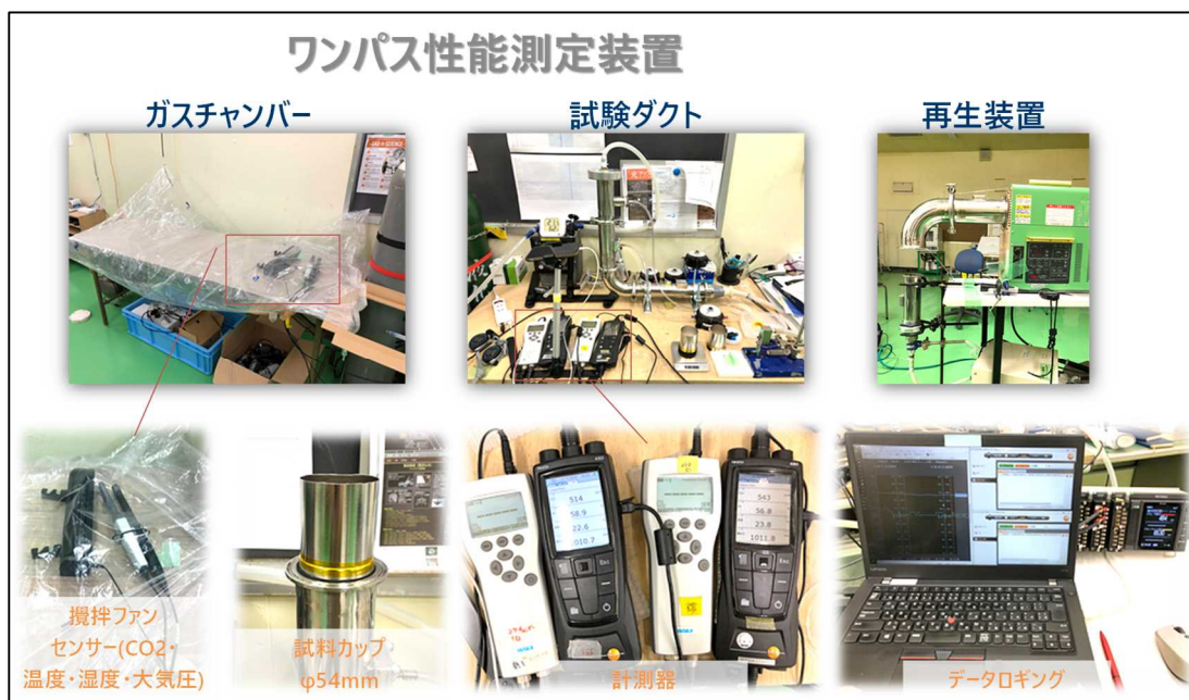
図Ⅲ-2.2.1.3-5 進和テックの水分吸着量試験装置構成
