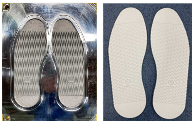
図Ⅲ-2.2.1.7-12 金型（レディース）とプレス成型品
