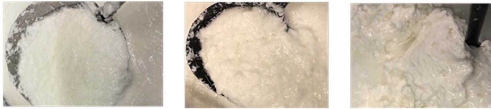
図Ⅲ-2.2.1.5- 7.凝固直後の MB クラムの写真 (左 ; 従来 CNF、中 ; 開発 CNF、右 ; 分散剤、凝固条件不適例)
