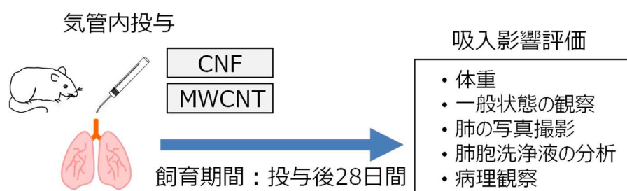
図Ⅲ-2.2.2-11 肺疾患モデル動物を使った CNF の気管内投与試験
