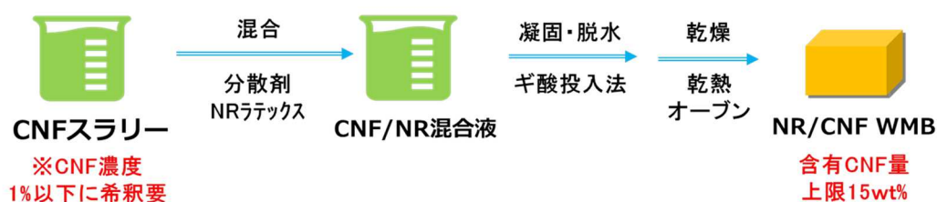
図Ⅲ-2.2.1.5- 6 WMB 製造工程図
