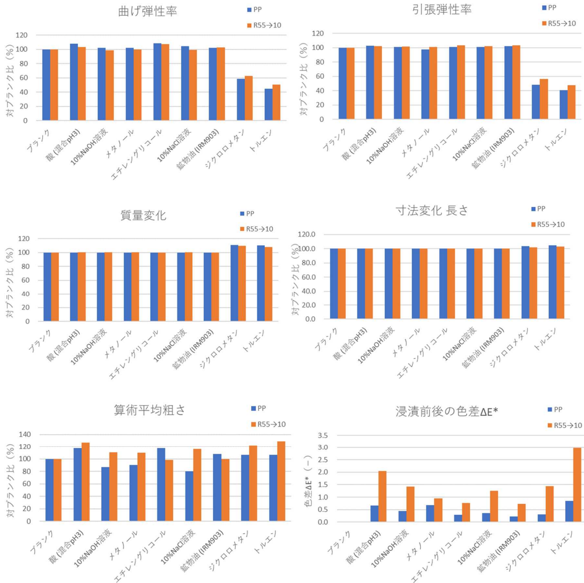
図Ⅲ-2.1.5-24 CNF複合樹脂の化学安定性試験の結果
