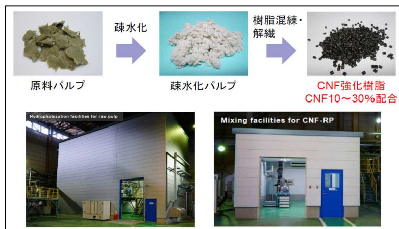
図Ⅲ-2.1.3-2. CNF強化樹脂製造工程と実証設備
