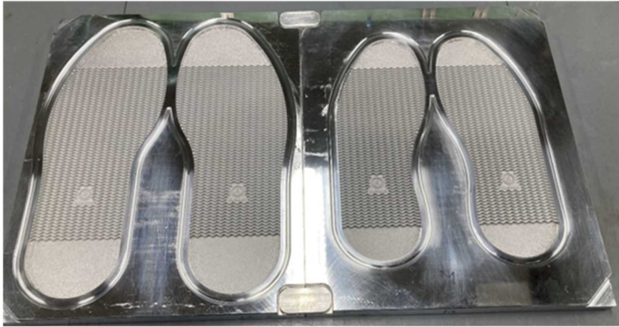
図Ⅲ-2.2.1.7-13 金型（メンズ）と金型（レディース）のジョイント
