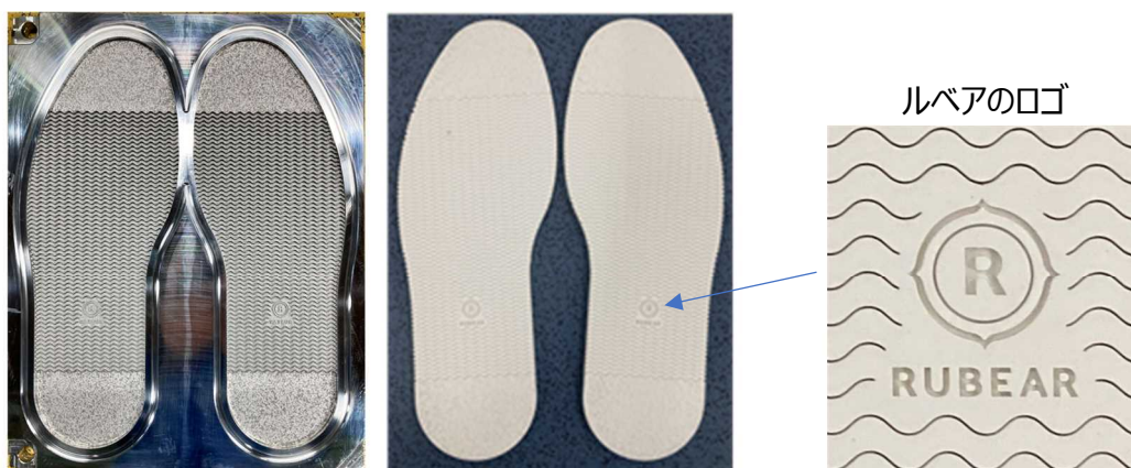
図Ⅲ-2.2.1.7-11 金型（メンズ）とプレス成型品
