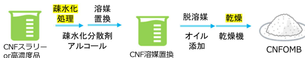
図 III-2.2.1.5-10 OMB 製造工程図
