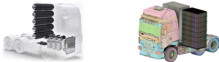
図. 大型商用車向け高压水素容器の概念図
