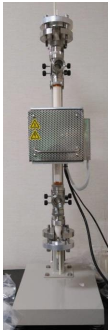
図1 立上げた水素透過測定装置
