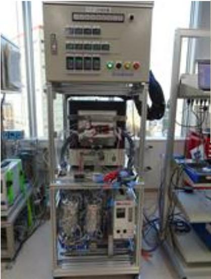
導入したボタンセル評価試験装置
