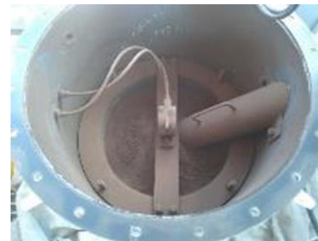
異物分級機閉塞、捕捉の木質成分
