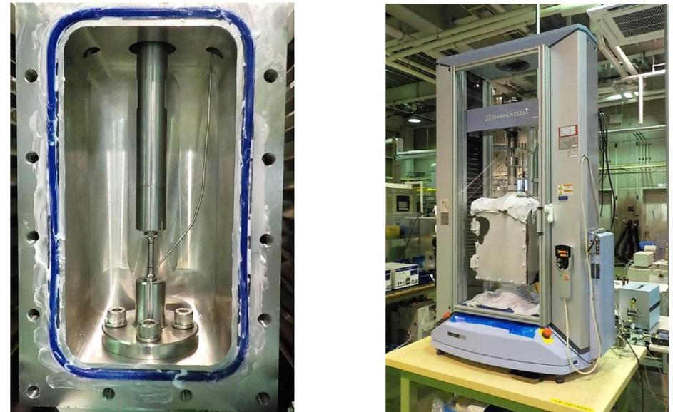
低歪速度引張試験 (SSRT試験) 装置
