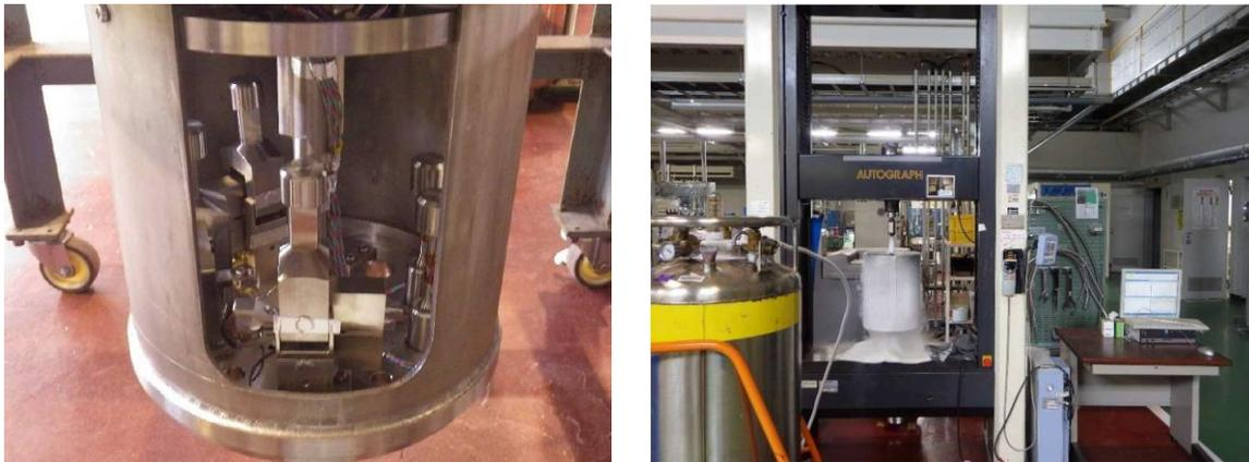
破壊靱性試験 (J<sub>IC</sub>試験) 装置
