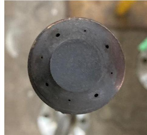
高圧水素燃焼時にも①安定燃焼、②安定した火炎検出可能、③ノズル損傷なし
