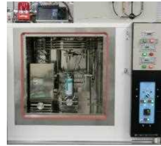
図1 自然発熱性評価試験装置 (R70試験装置)
