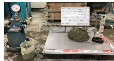
図4.2.1-1 : コンクリート配合選定試験の様子
