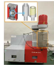
図2 精密TG-DSC装置 (熱の捕捉率が従来のDSCと比較して、大幅に優れた装置)
