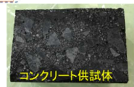
図2 本技術のセメントレスコンクリート
