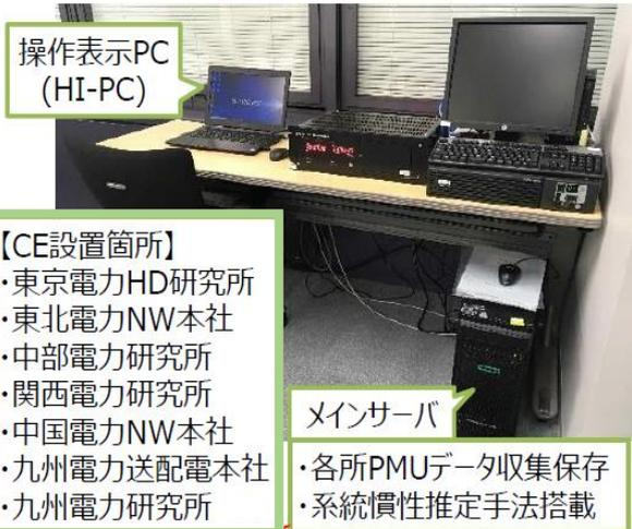
PMU(Phasor Measurement Unit : 同期フェイザ測定装置)
