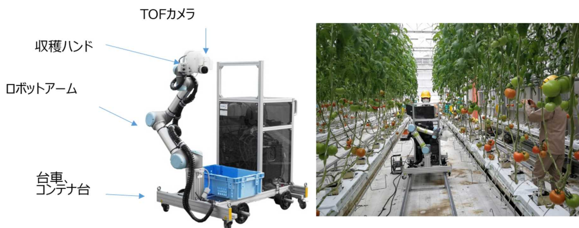
図 3-65. 「トマト収穫ロボット試作 6 号機」外観と収穫試験の様子
