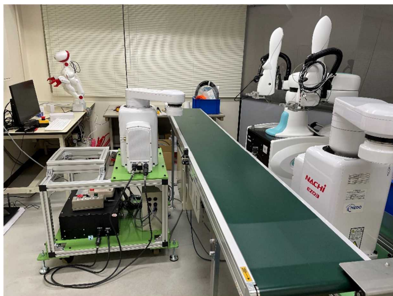
図 3-15. スカラ型ロボット 2 台に拡張したピックアップ・プレーシングロボット実験装置
