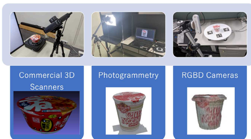
図 3-5. 形状データ作成手法と得られた 3D データの評価
