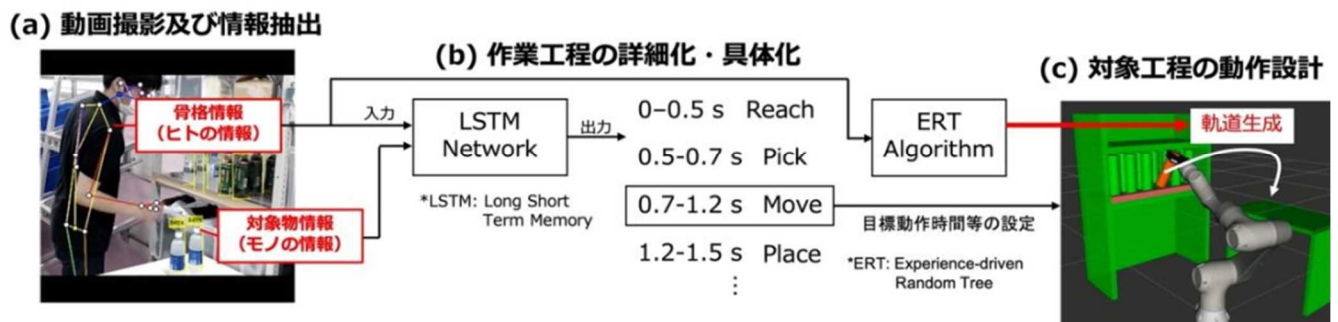
図 3-16. 人手作業動画からの設計変数抽出過程を含めたロボット動作計画・機器配置問題同時最適化アルゴリズム
