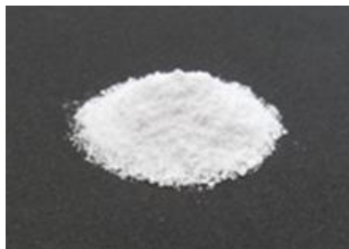
図Ⅲ-2.2.3-21 例：ポリエステル系構造を有する化合物の粉体写真（熔融温度 80℃）
