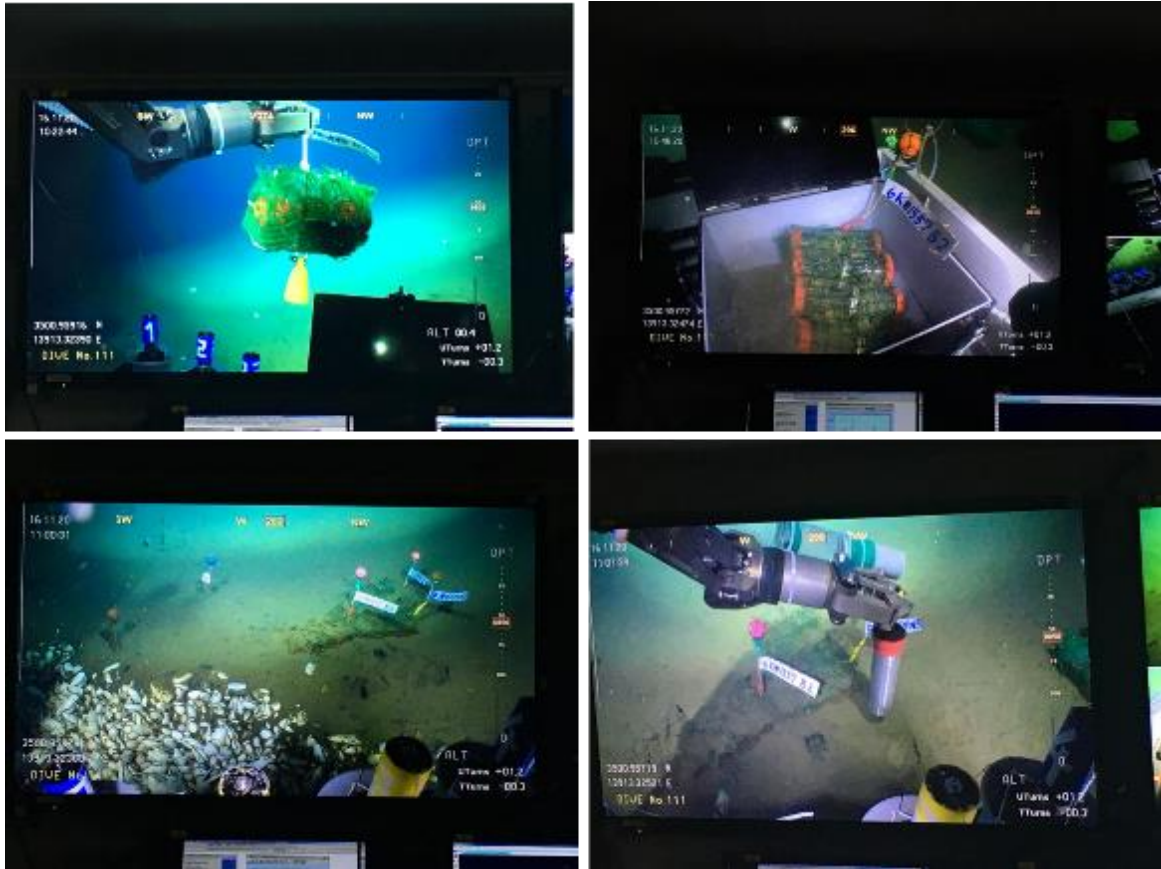
図Ⅲ-2.1.11-4 しんかい 6500（有人潜水艇）のマニピレーター（ロボットアーム）を用いたサンプルおよび海底土の設置・回収の様子 （左上）サンプル設置の様子、（右上）サンプル回収の様子（海底土と深海水も同時に回収）、 （左下）サンプル回収後の海底の様子、（右下）サンプルの下の海底土の採取
