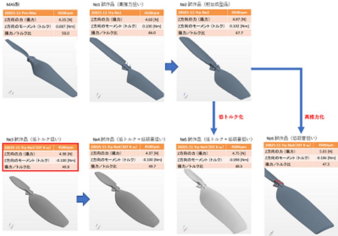
図 III- 5 6 アジャイル開発過程でのプロペラ形状の変遷
