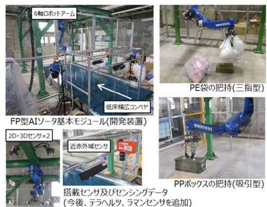
図 3.2-1 「高度選別システム開発（フィールドピックアップ型 AI ソータ）」における開発内容
