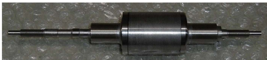
図 B-3-2-1 積層構造磁石モーターロータ (アーマーリング焼き嵌め前。インペラ、スラストカラー等は外した状態)
