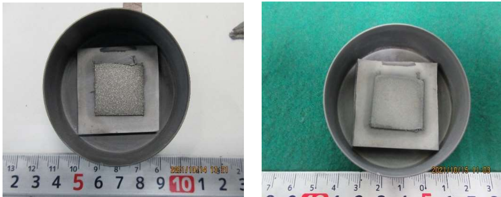
図 A-1-1-2 2-17 系 SmCo 系磁粉の熱処理前後外観写真(左は熱処理前、右は熱処理後)
