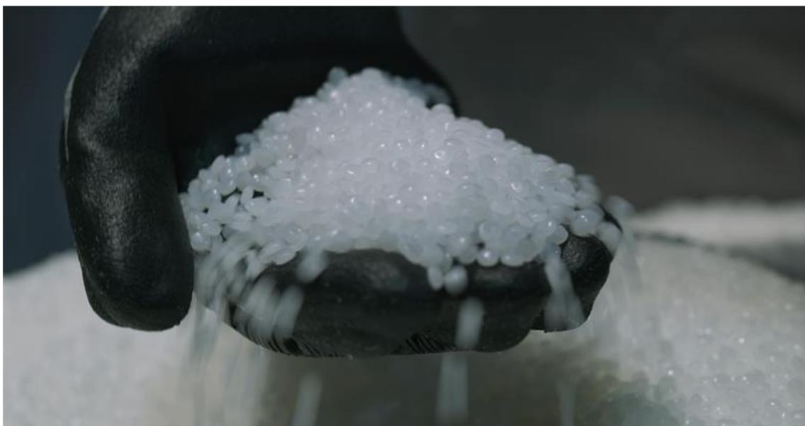
新しいプラスチック製品の製造に使用できるプラスチックペレット。混合可燃性廃棄物を 600—800°Cに加熱したガスから生産される。写真: Johan Bodell, Chalmers
