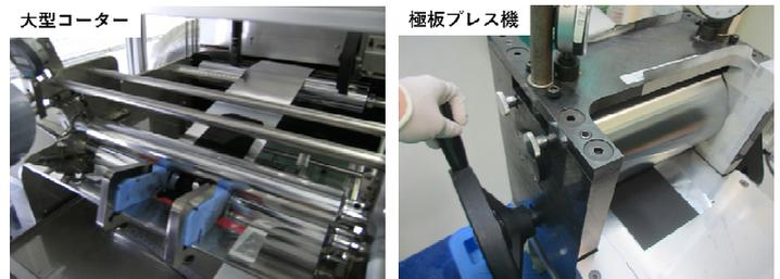
図 V2-12 大型コーターおよびプレス機
