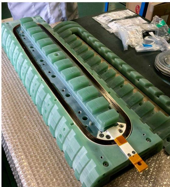
図 V1-1 試作した界磁コイルモデルの外観
