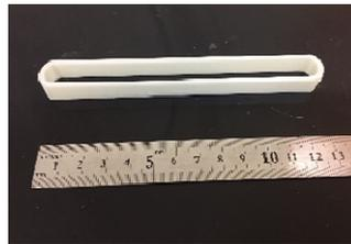
図 V1-5 開発したアルミナ FRP 製支持体の外観
