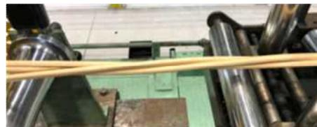
図 V1-9 積層導体の三相撚線加工
