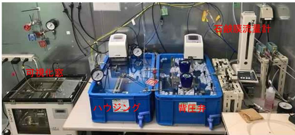
図 3.2.2.1-72 高圧 CO<sub>2</sub> 膜透過・溶液濃縮試験装置の外観
