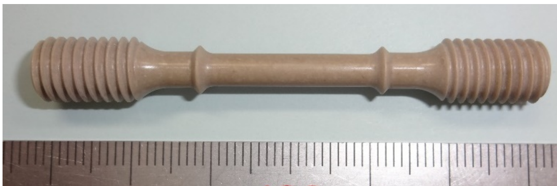
図 4.5-5 開発 CMC のクリープ試験片
