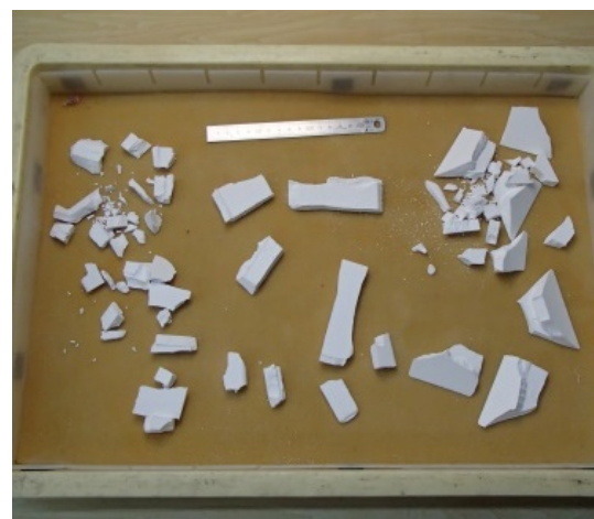
図 4.4-7 鑄型-中子一体造型品 (焼成体)
