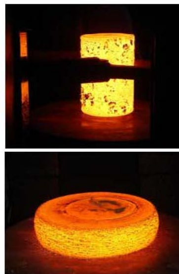
図 4.5-10 開発 TiAl 合金 の熱間鍛造の状況
