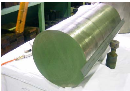
図 4.5-9 開発 TiAl 合金の大型 インゴット（ \phi 300\text{mm} \times 500\text{mm} 、 145kg）
