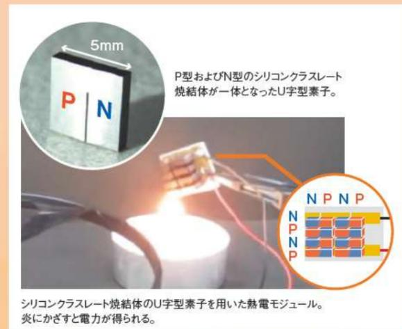
シリコンクラスレート焼結体のU字型素子を用いた熱電モジュール。
