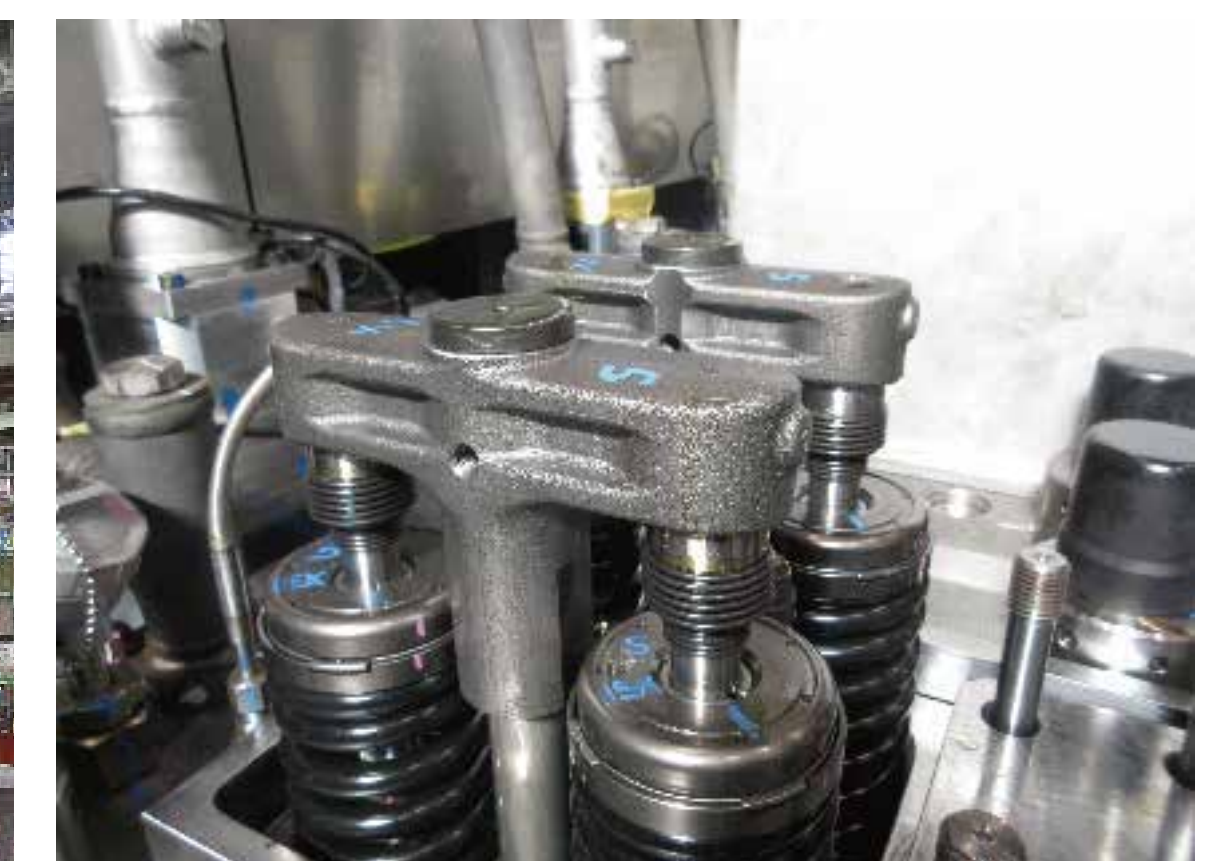
弁隙間自動調整装置 HLA(Hydraulic Lash Adjuster)
