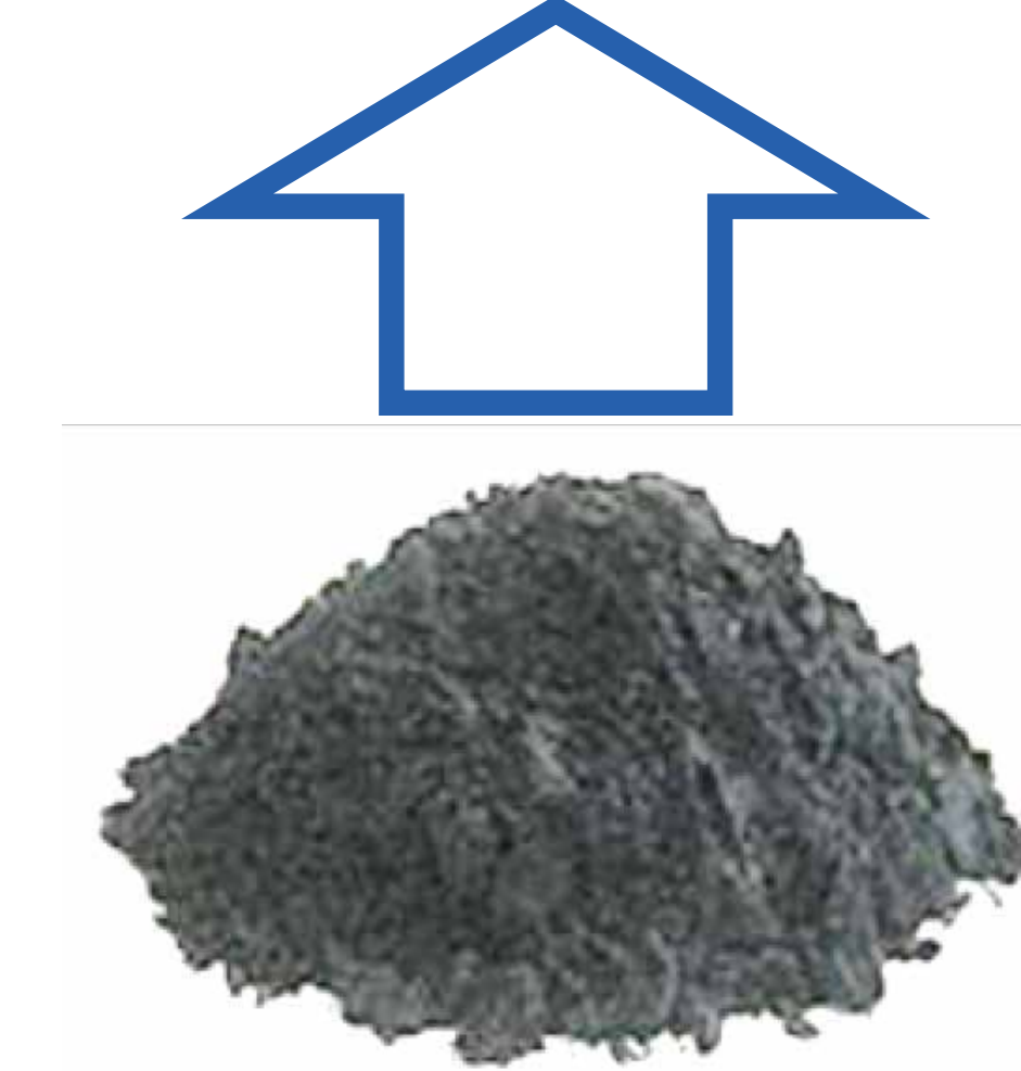
粉末状CMSを直接合成 ※既存のペレット状CMSを粉砕すると細孔が破壊され分離能が消失する
