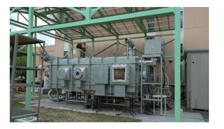
また、被加熱物への影響では、アンモニア混焼雰囲気下での加熱テストが完了しており、性状分析を進めている段階です。引き続き、アンモニア混焼比率を高くしていき、影響度合を継続調査します。
