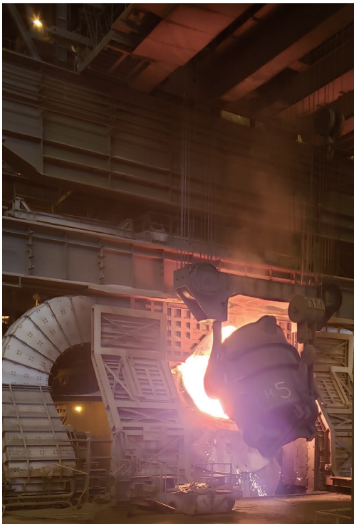
ISP Burnpur工場 転炉設備
