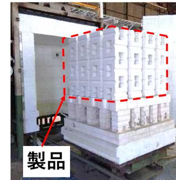
現在、製品を積載し、実炉条件に合わせた加熱テストを実施しています
