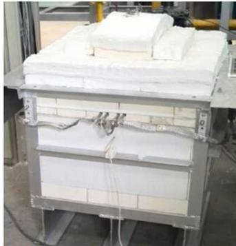
小型電気炉(炉内容積約0.01m<sup>3</sup>)
