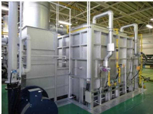
バッチ式高温用ガス焼成炉
