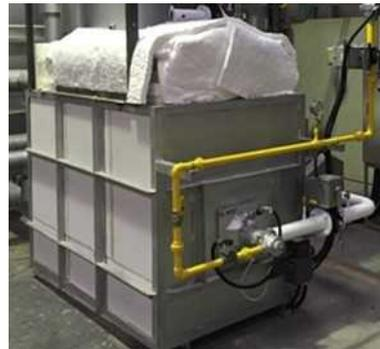
小型ガス炉(炉内容積約0.7m<sup>3</sup>)
