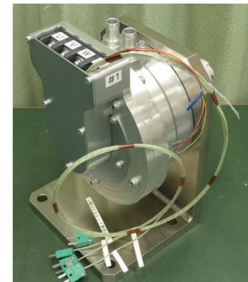
図4 開発した可変界磁モータ
