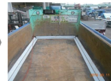
フッ素樹脂とステンレス鋼板の接合品を荷台に設置
