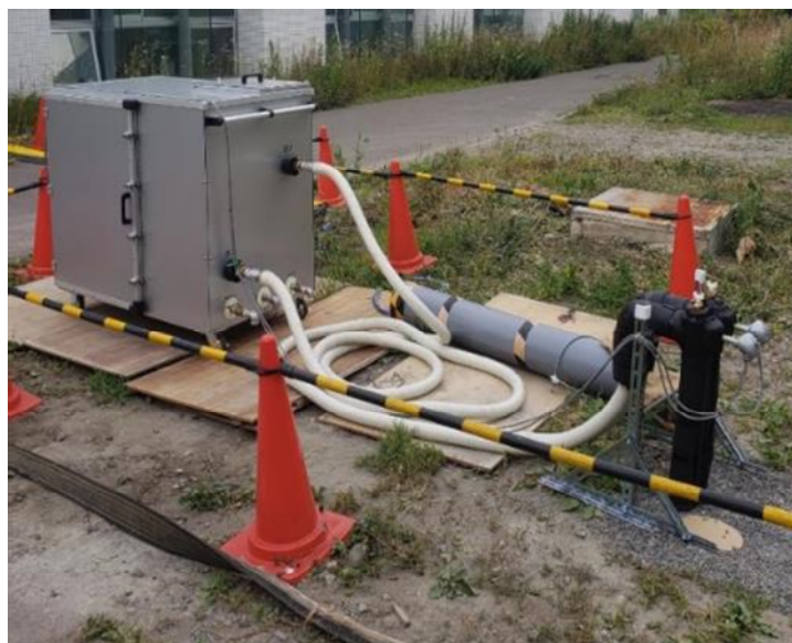
大深度BHE対応 周期加熱法のためのTRT試験機
